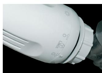
В положении ⚡ фиксация, температурная настройка блокируется в требуемом положении. Например: зафиксируйте ручку регулятора терmostaticкой головки в положении «3», а ограничительное кольцо - в положении ⚡ фиксация. Таким образом, терmostaticкая головка остается в положении «3», и дальнейшее изменение настроек невозможно.
