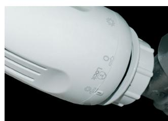
В положении ● → режим настройки ограничен диапазоном от 0 до требуемого значения параметра настройки. Например: зафиксируйте ручку регулятора терmostaticкой головки в положении «3», а ограничительное кольцо - в положении ● →. Таким образом, вы сможете полностью открыть терmostaticкую головку, или полностью закрыть ее в положении максимального закрытия «3».
