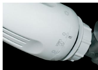
В положении 0 → режим настройки ограничен диапазоном от 0 до требуемого значения параметра настройки. Например: зафиксируйте ручку регулятора терmostатической головки в положении «3», а ограничительное кольцо - в положении 0 →. Таким образом, вы сможете полностью закрыть терmostатическую головку, или полностью открыть ее в положении максимального открытия «3».
