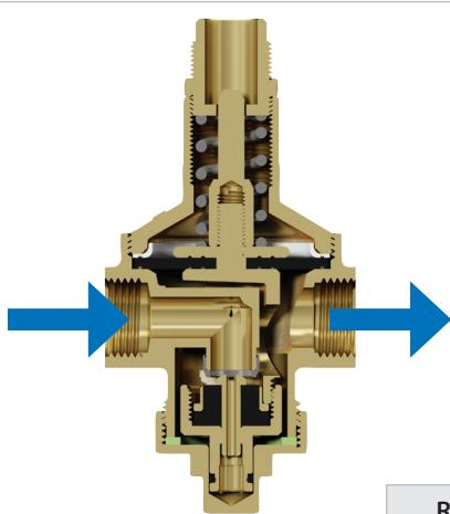
Эластичная мембрана приводит в действие запорный клапан в результате взаимодействия двух противоположных сил: снизу давление воды на выходе из регулятора (действие направлено на закрытие клапана), сверху давление возвратной пружины, зависящее от рабочего давления (действие направлено на открытие клапана).
