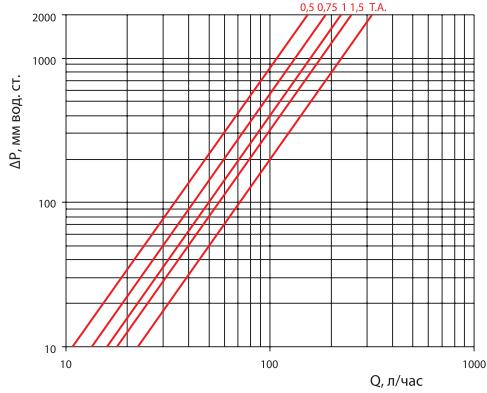
$\Delta T = 2\text{K}$  для термостатического клапана с предварительной настройкой
