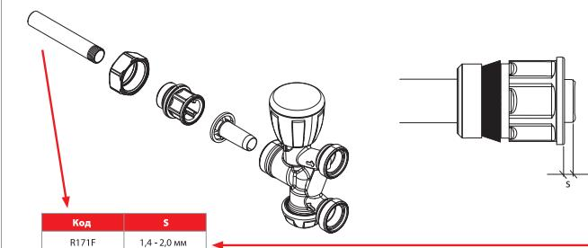
Для моделей, требующих использования зонда на приемном патрубке мод. R171P или R171C
