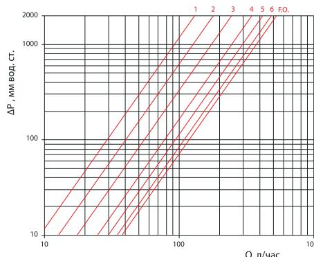
ΔT=2K для термостатического клапана, клапан двойной регулировки полностью открыт
