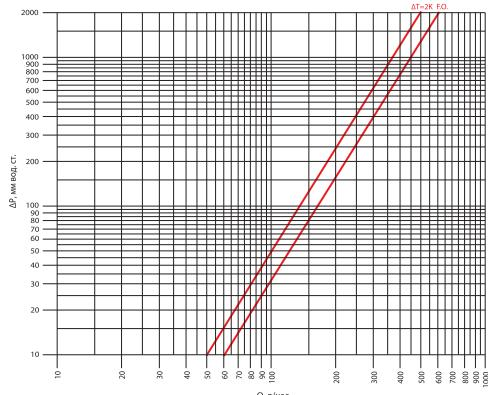
ΔT=2K для терmostатического клапана, клапан двойной регулировки полностью открыт
