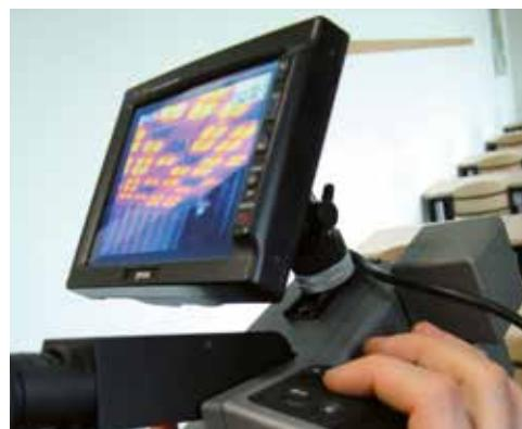
**рис. 1.4 Термовизионная камера**
